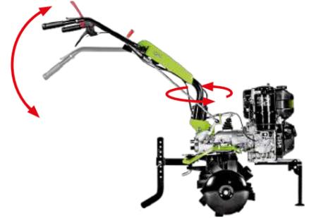
Dos son las **tomas de fuerza**: una superior directa al régimen del motor en sentido antihorario, con eje estriado 11 UNI 221; una inferior mandada por el cambio en sentido horario, con eje estriado 13 UNI 221.
