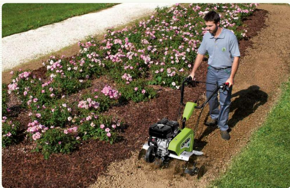
**Los discos laterales** sirven para mantener en línea recta a la máquina y delimitar con precisión la zona labrada.
