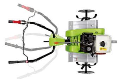
**La fresa** estándar mide 97 cm de ancho y permite una profundidad de arado hasta los 33 cm. Está compuesta por 6 estrellas de cuchillas con discos laterales. Las cuchillas de acero templado están aseguradas por medio de tornillos con tuercas. El eje de las cuchillas es **hexagonal** de 27 mm.
