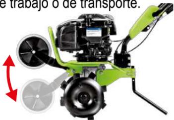
**La fresa** estándar de G Z1 y G Z2 se compone de 4 elementos de cuchillas con discos laterales. Mide 57 cm de ancho y, gracias al juego de alargamientos, puede llegar a 80 cm o ser reducida a 35 cm (2 elementos). **La fresa** estándar de G Z3 se suministra de serie con el juego de alargamientos (6 elementos). La profundidad máxima de trabajo es de 28 cm. Las azadas, hechas de acero templado, se fijan por medio de tornillos con tuercas.
