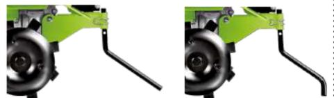
Uno para terrenos suaves y arenosos. Otro para terrenos duros.
