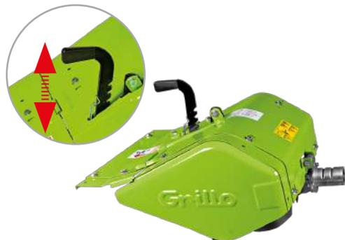
**La profundidad de fresado** se regula a través de una palanca colocada en el exterior del capó de la fresa. Para un resultado óptimo, es posible regular también la **cuchilla central** en 3 posiciones: para terrenos duros, normales y suaves/arenosos.
