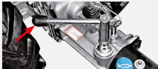
**El embrague es de tipo activo:** al soltar la palanca, las ruedas y el accesorio se detienen inmediatamente y el motor permanece en marcha. El avance y la PTO tienen mandos independientes. Un **dispositivo de seguridad** impide la activación de la PTO con la marcha atrás en funcionamiento.
