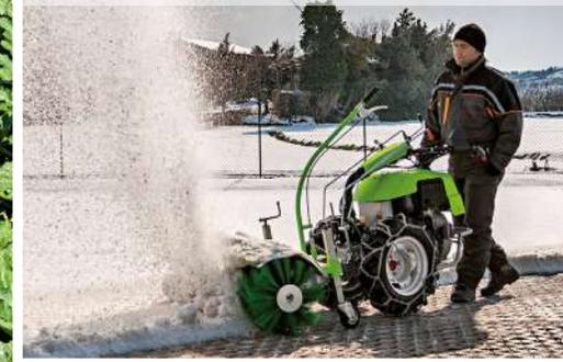
**Embrague activo:** abandonando el manillar se desactivan inmediatamente las ruedas y el accesorio, pero el motor no se apaga. La tracción y la toma de fuerza tienen mandos independientes. Un **dispositivo de seguridad** impide la activación de la PTO con la marcha atrás en funcionamiento.
