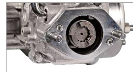
La brida de montaje de los accesorios es de acero, el árbol de la PTO tiene un **diámetro de 25 mm** y un **acoplamiento de 3 dientes**. El enganche rápido opcional permite intercambiar los accesorios sin necesidad de otra herramienta.
