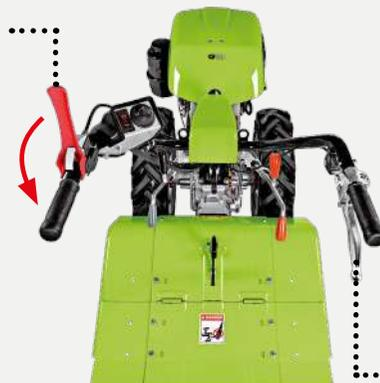
**El diferencial** ayuda en las maniobras y en los desplazamientos del motocultor. Al bloquear el diferencial, se obtiene un avance recto y regular que facilita el trabajo. La palanca de bloqueo del diferencial, colocada sobre el manillar, está siempre al alcance de la mano.
