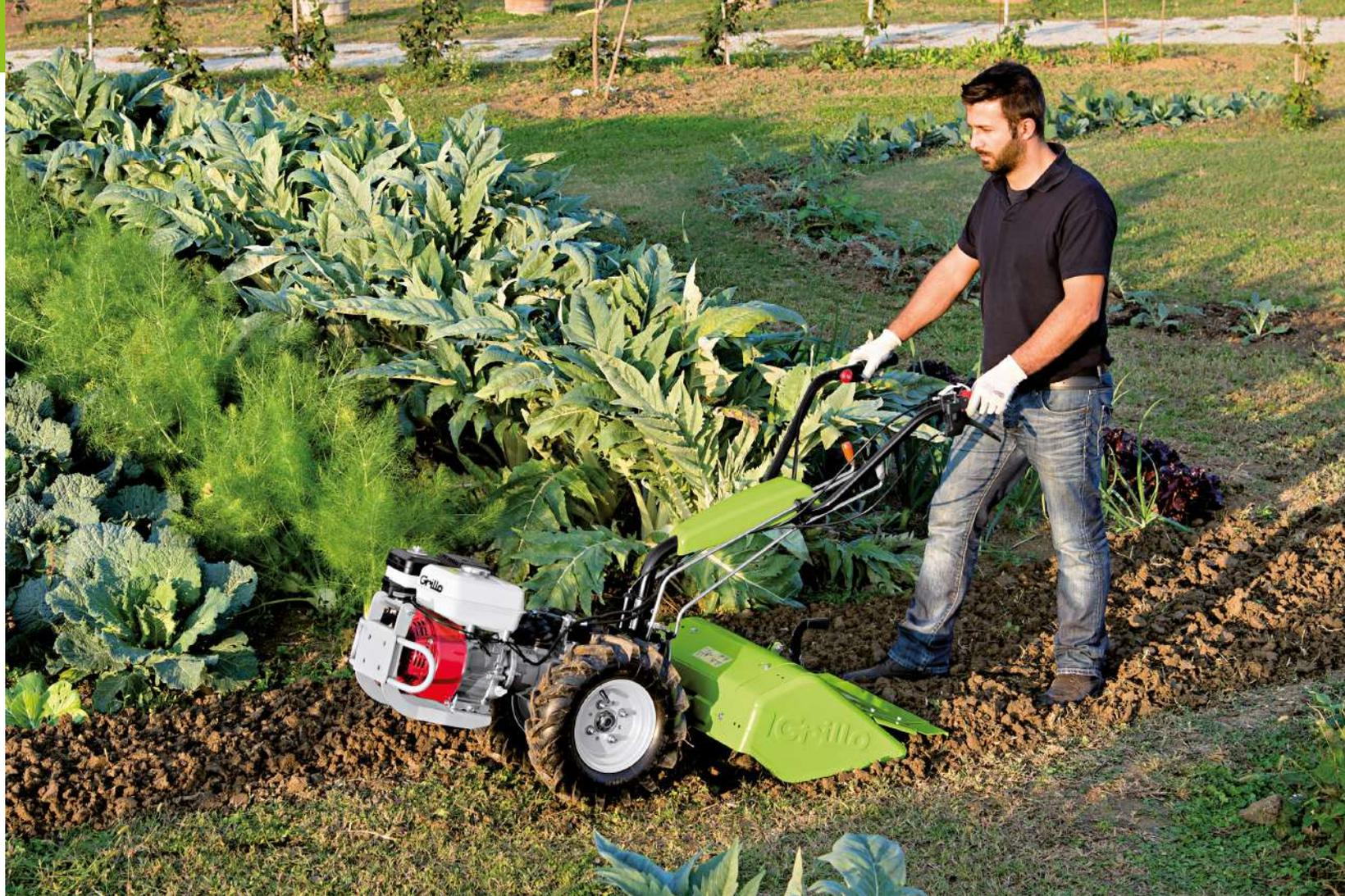
**El embrague es de tipo activo:** al soltar la palanca, las ruedas y el accesorio se detienen inmediatamente y el motor permanece en marcha. El avance y la PTO tienen mandos independientes. Un **dispositivo de seguridad** impide la activación de la PTO con la marcha atrás en funcionamiento.
