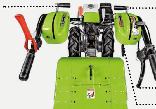
La palanca de marcha atrás está colocada sobre el manillar. Al activar la marcha atrás, el desacelerador automático limitará la velocidad.
