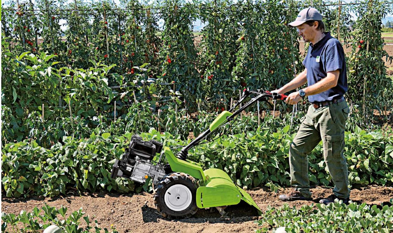
Un **acoplamiento** de tipo “activo” rige el avance: al soltar la palanca, las ruedas se detienen inmediatamente y el motor permanece en marcha. El avance y la PTO tienen mandos independientes. Un **dispositivo de seguridad** impide la activación de la fresa en marcha atrás.
