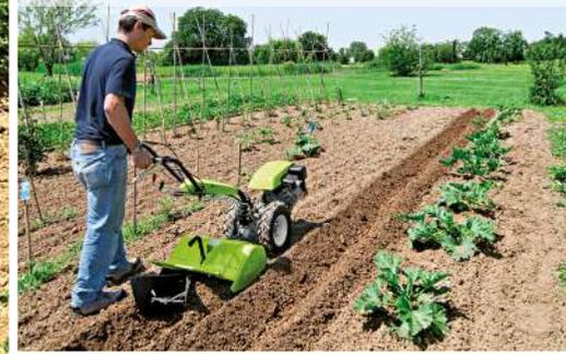
El G 55 dispone de **enganche rápido** de serie para poder intercambiar rápidamente los diferentes accesorios. Una cómoda palanca permite asegurar los implementos al motocultor, sin necesidad de herramientas.
